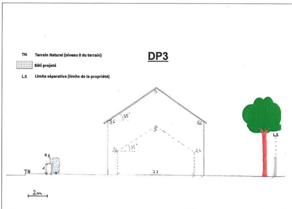
*Dans le Plan Local d'Urbanisme de Pontault-Combault, les hauteurs sont mesurées à partir du sol naturel avant travaux. L'usage veut que celui-ci soit mentionné sur le plan de coupe. Ajoutez l'indication « TN ».*
