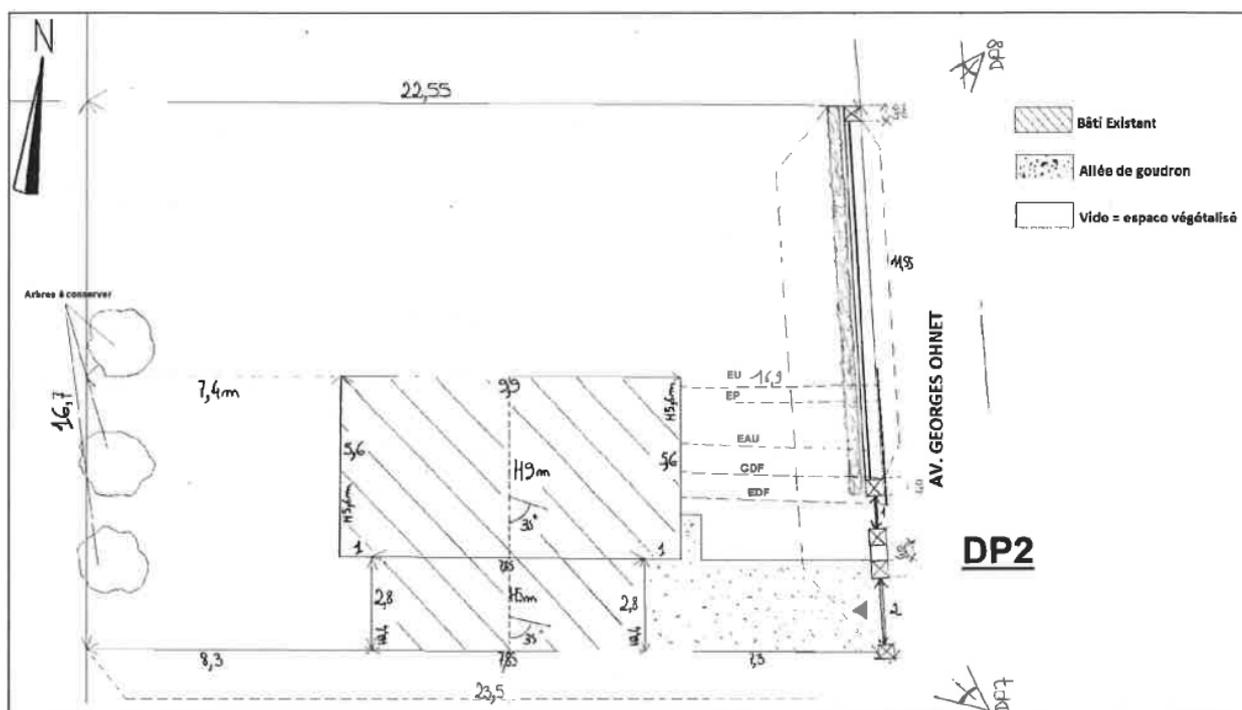
Vous devez indiquer sur le plan son échelle et l'orientation, c'est-à-dire la direction du Nord (Art. A. 431-9 du code de l'urbanisme) ainsi que les cotes, en 3 dimensions (longueur, largeur et hauteur) 1). Choisissez une échelle permettant de représenter le projet dans le terrain.
